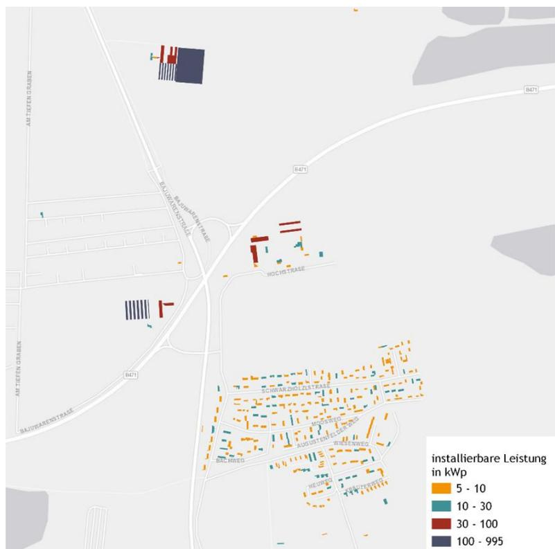
Abbildung 39: Installierbare Leistung Aufdach im Bereich der „Handwerkersiedlung“, Karlsfeld (Quelle: INEV)
