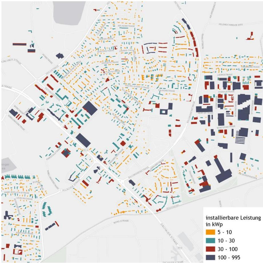
Abbildung 38: Installierbare Leistung Aufdach im Zentrum Karlsfelds (Quelle: INEV)
