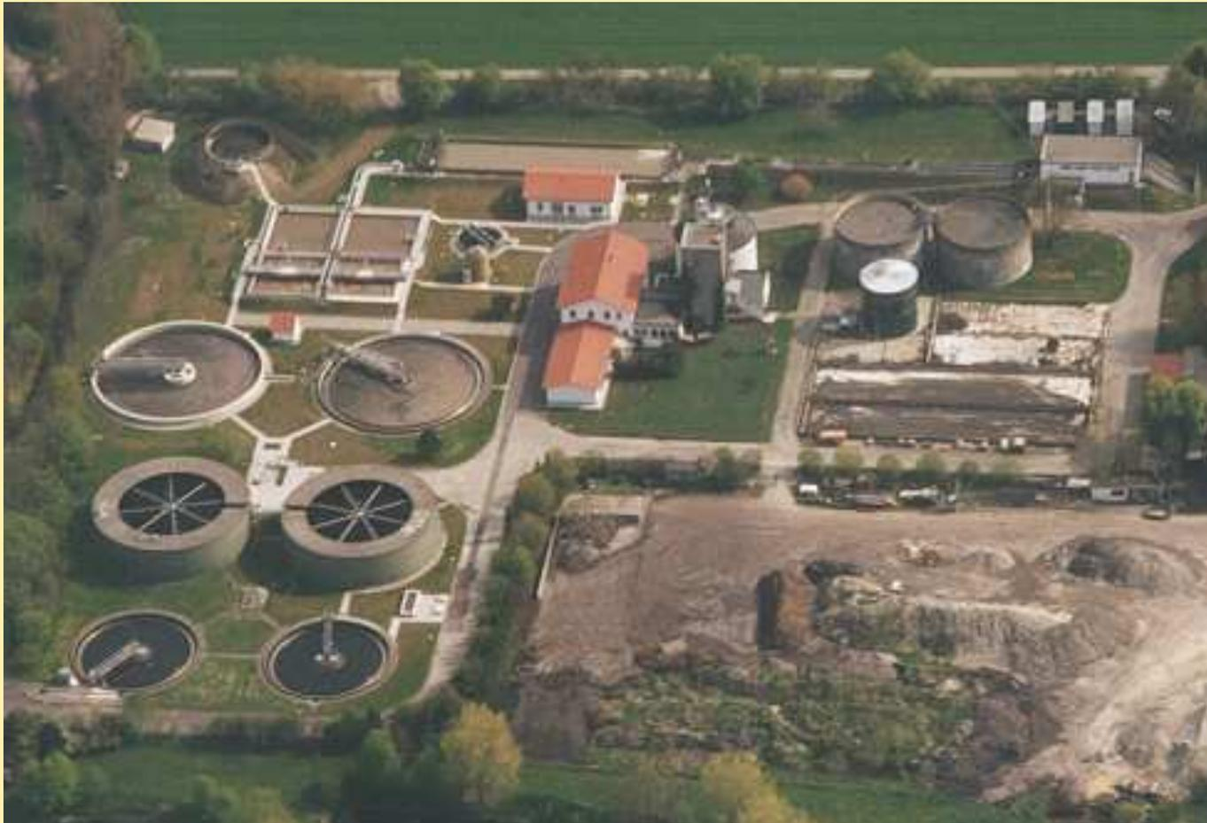
2000: Umbau der Belebung zur Denitrifikationsstufe
